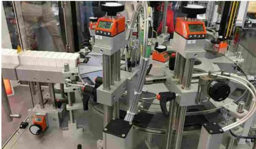
Nuova serie di indicatori di posizione elettronici con sistema wireless, a radiofrequenza.
