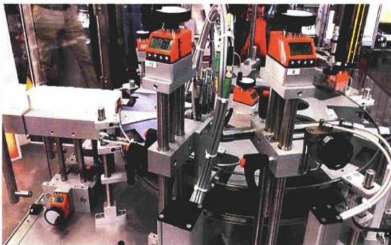
● Applicazione degli indicatori di posizione elettronici DD52R-E-RF di Elesa su una macchina per imballaggio.
