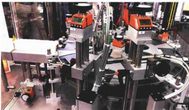
● Applicazione degli indicatori di posizione elettronici DD52R-E-RF di Elesa su una macchina per imballaggio.
