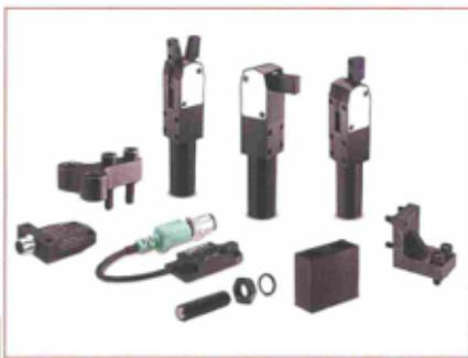
Gli attrezzi di serraggio pneumatici **Elesa** sono caratterizzati da un'elevata forza di bloccaggio, dimensioni ridotte, basso consumo di aria compressa e peso ridotto. Realizzati in acciaio brunito, con cilindro pneumatico disponibile in diversi diametri (20, 32, 40 o 50 mm), possono esercitare un range di forze comprese tra i 120 e i 950 daN.
