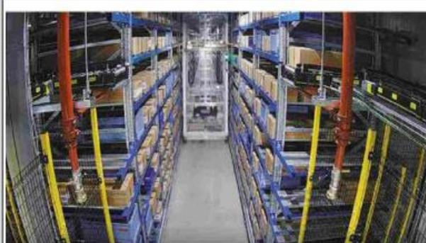
Uno dei numerosi shuttle che operano all'interno del magazzino automatico.
