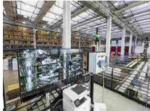
La "Control Room" con gli schermi del sinottico sul quale sono rimandate le immagini delle telecamere di controllo montate sui singoli shuttle. The Control Room with summary screens to which the images of the control cameras mounted on the individual shuttles are sent.
