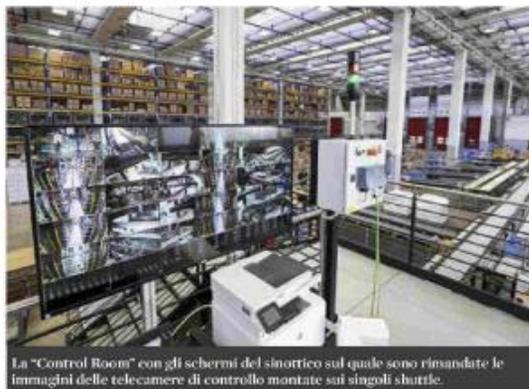
La "Control Room" con gli schermi del sinottico sul quale sono rinviate le immagini delle telecamere di controllo montate sui singoli shuttle.
